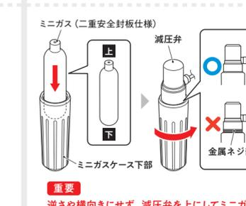
**重要** 逆さや横向きにせず、減圧弁を上にしてミニガスケース下部をねじ込んでください。傾けると安全装置が作動し、ガス漏れ音や冷気が噴出して大きな音がすることがあります。
