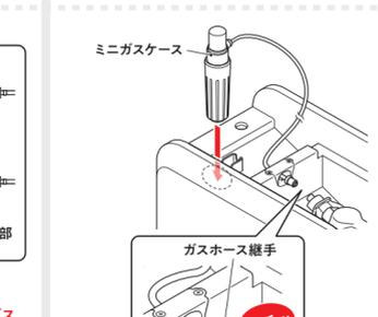
ミニガスケースをサーバー内に格納し、ガスホース継手を中栓のガス供給口にまっすぐ差し込みます。
