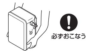
本体は安定した水平な場所に設置して使用する
