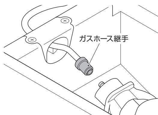
**!** ミニ樽未装着時は、中栓にガスホース継手が接続できないようになっています。未接続の状態で保管してください。
