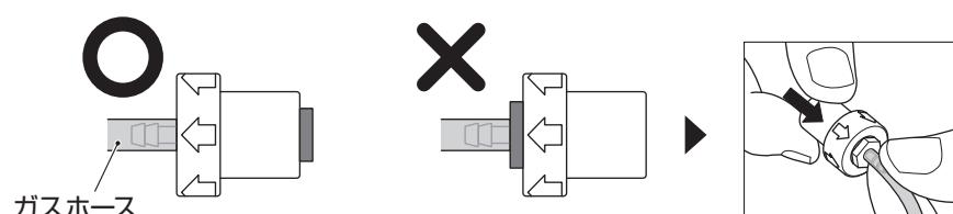
※ガスホース継手は中栓のガス供給口に対して、まっすぐに抜き差ししてください。
